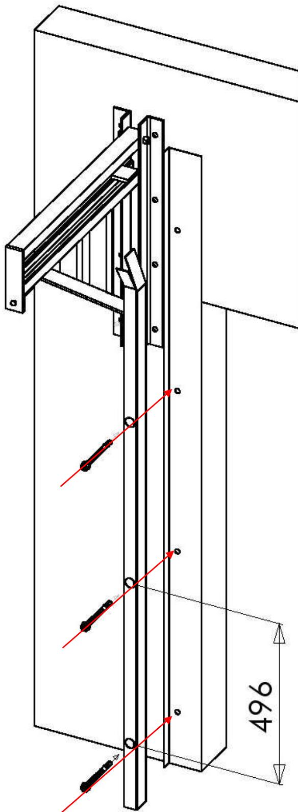
В бетон (кирпич) крепление производится анкерными болтами 8 x 50 мм. К металлоконструкции ям возможно крепление либо при помощи сварки, либо саморезами с шестигранной головкой D10.
