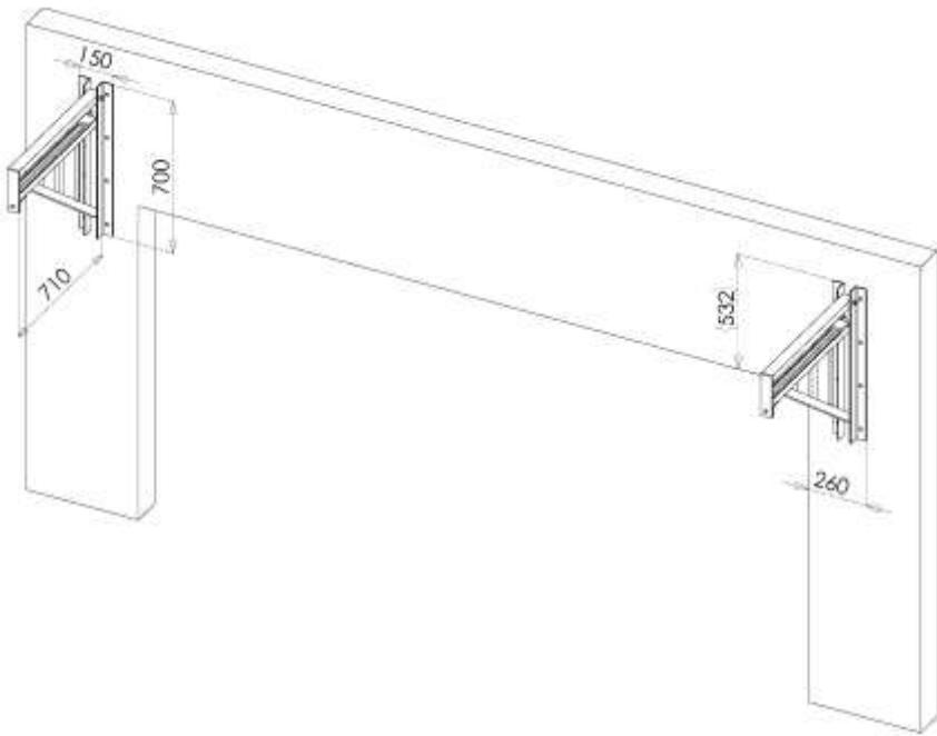
К кирпичной или бетонной стене крепление производится анкерными болтами 10 x 120 мм. К металлоконструкциям возможно крепление при помощи сварки.
